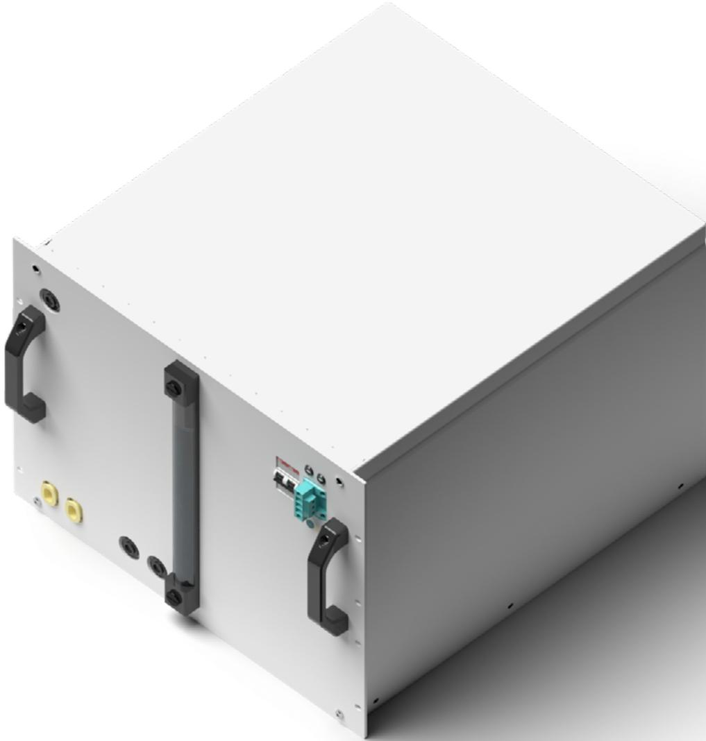
Enapter 的水箱模块可为电解槽提供 35 升的净水。水箱可机架安装到标准的 19 英寸机柜中。可以通过我们的净水系统或任何其他合适的净水供应水箱。该水箱包含一个泵系统，可为多达 30 个电解设备提供净水。
