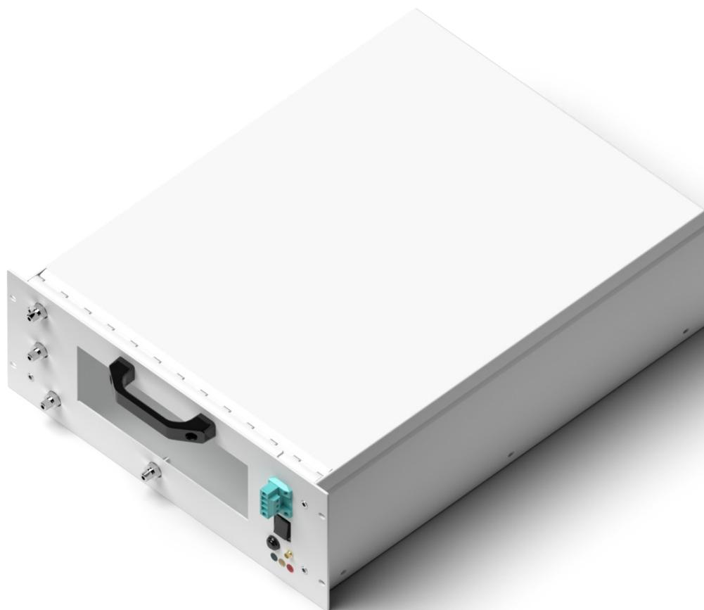
Enapter 的干燥机是一个变温/变压混合吸附系统，它包括两个装有高吸附性材料的滤筒。这台干燥机是免维护的。在操作期间，一个滤筒用于吸收来自电解槽氢气流中的水分，另一个滤筒被加热并再生。该机架式干燥机可以安装在标准的 19 英寸机柜中。
