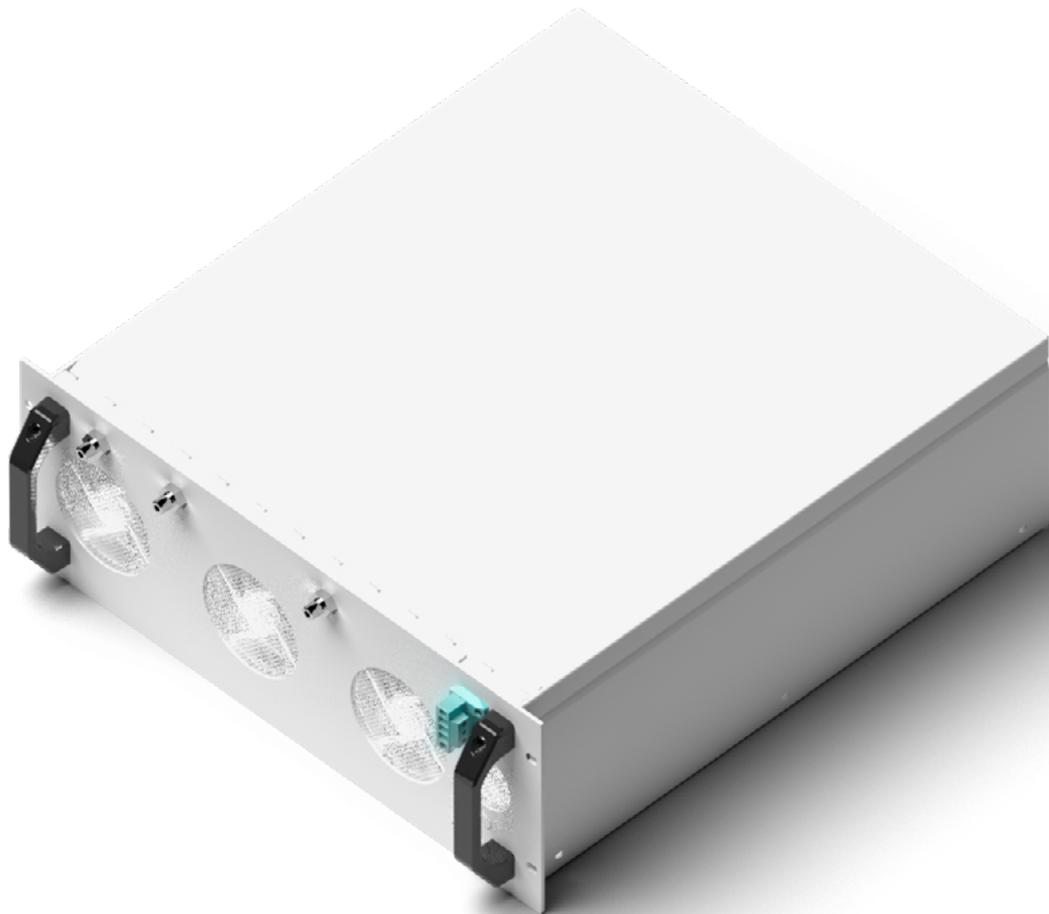
Enapters Trockner ist ein hybrides Temperatur-/ Druckwechseladsorptions-System. Es besteht aus Kartuschen, die mit einem stark adsorbierenden Material gefüllt sind. Der Trockner operiert völlig wartungsfrei. Während des Betriebs fängt eine Kartusche die Feuchtigkeit aus dem Wasserstoffstrom aus dem Elektrolyseur auf, während sich die andere Kartusche erwärmt und regeneriert. Der Trockner kann in ein 19-Zoll-Standardgehäuse eingeschoben werden.
