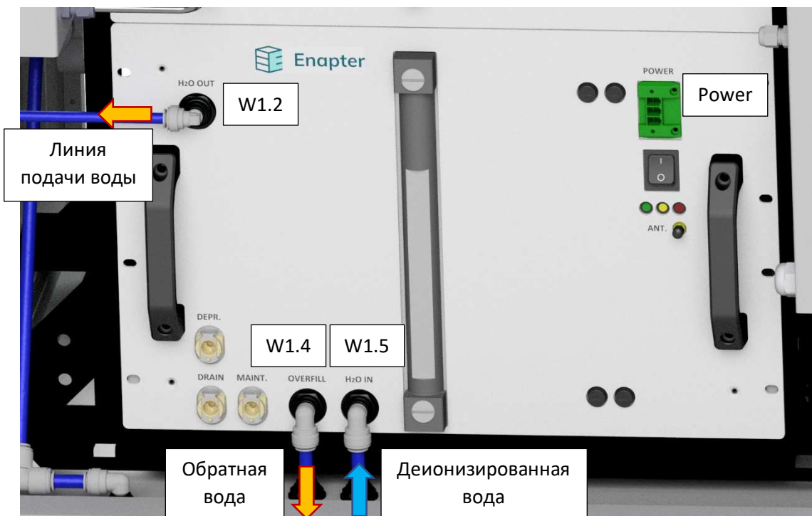
Рисунок 13: Подключения Водяного бака
